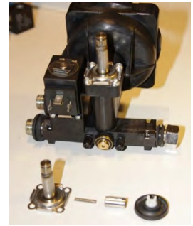
4.b. Electroválvulas. Válvulas 2 vías NA y NC.
