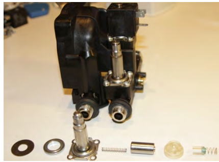
4.b. Electroválvulas. Válvulas 2 vías NA y NC.
